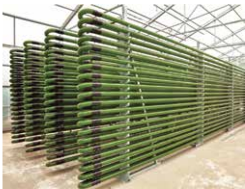
Рис. 36. Установка для выращивания хлореллы
