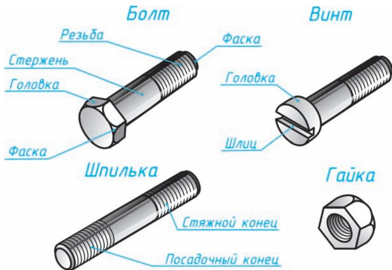
Рис. 161. Крепежные детали
