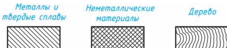
Рис. 123. Графические обозначения материалов в сечении
