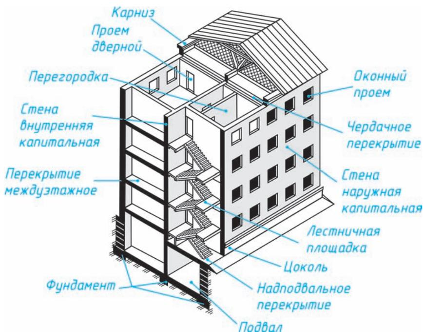
*Рис. 186.* Части и элементы здания
