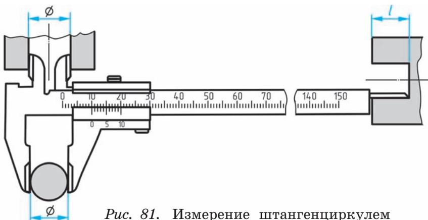
Рис. 81. Измерение штангенциркулем
