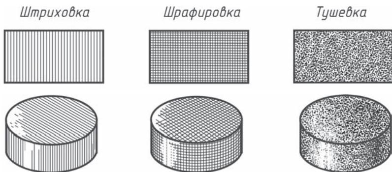
Рис. 65. Способы передачи объема предмета на техническом рисунке
