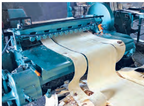
Рис. 160. Использование лущильного станка (Германия) для производства мебельного шпона
