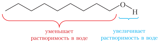
Рис. 23.8. Влияние углеводородного радикала и гидроксильной группы на способность спиртов растворяться в воде
