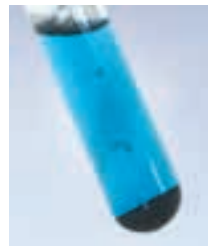
Рис. 33.1. Растворение оксида меди(II) в уксусной кислоте
