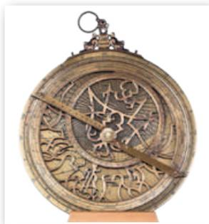
Астролябия — прибор, с помощью которого моряки измеряли в открытом море высоту звезд над горизонтом
