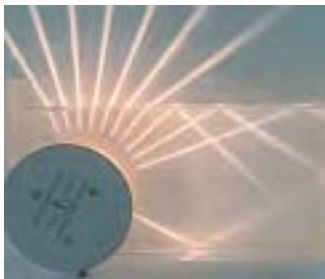
Рис. 133. Полное отражение света на границе раздела сред
