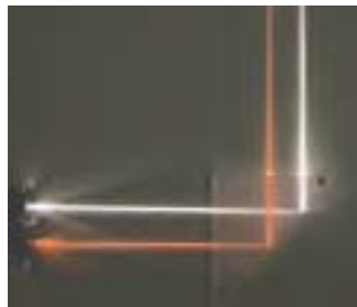
Рис. 133. Полное отражение света на границе раздела сред
