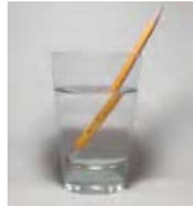
Рис. 129. Преломление света на границе раздела двух сред
