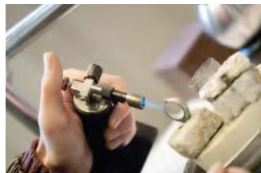
Рис. 66. Сварка ювелирных изделий кислородно-водородным пламенем
