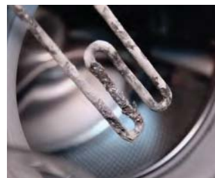
Рис. 112. Накипь на обогревательном элементе стиральной машины
