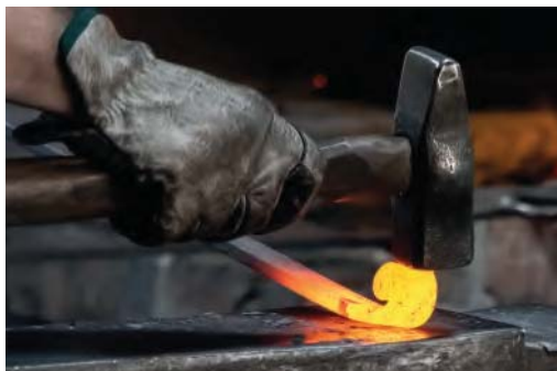
Рис. 104. Ковка металла как демонстрация его пластичности
