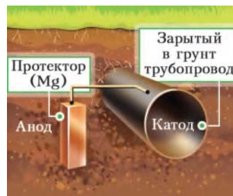
Рис. 116. Защита от коррозии подземного стального трубопровода
