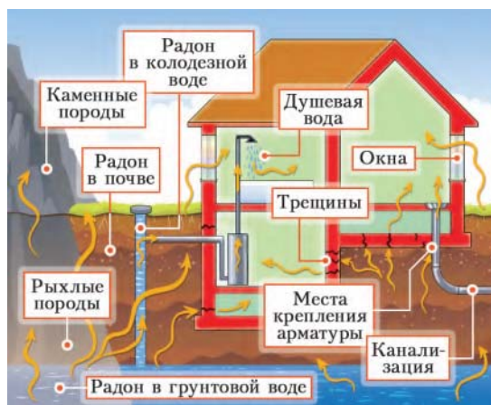
Рис. 14. Пути проникновения радиоактивного радона в жилые помещения
